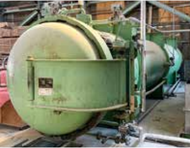
不燃処理装置
