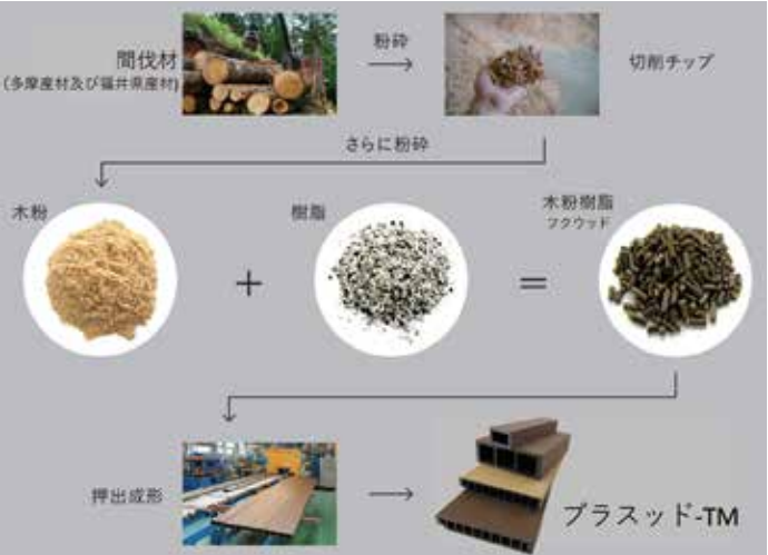
プラスッドーTMの生産工程
