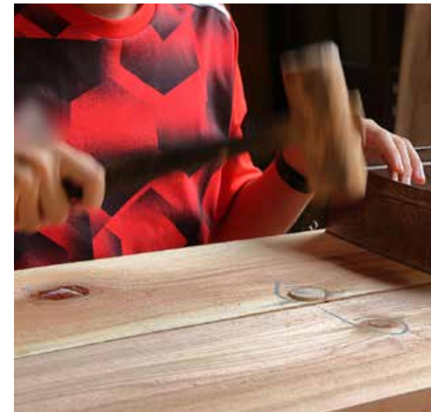
節埋めをしているところ
