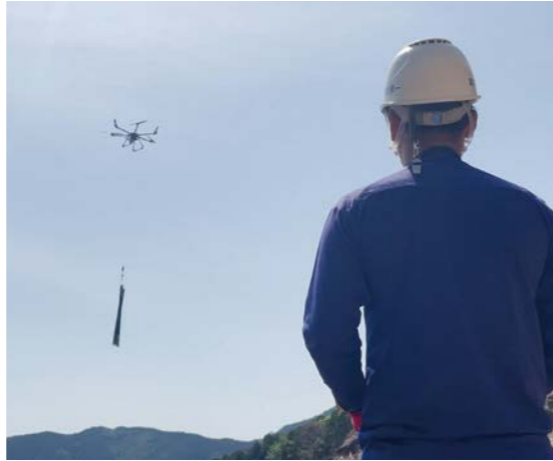
再造林に必要なシカ柵の資材を運搬するドローン
