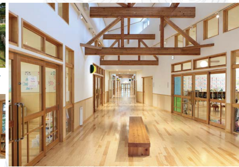
柱や梁、腰壁、床と、木がふんだんに使われている園舎内 ベンチは旧園舎で使われていた梁を再利用
